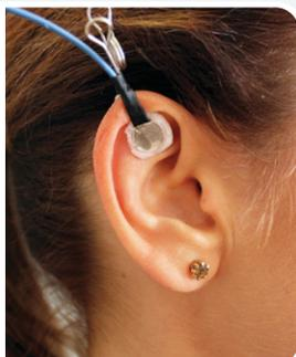
**7** Appliquez la pâte de la même manière sur le clip du capteur noir et pressez doucement sur le lobe de l'oreille. Pas besoin de retirer les boucles d'oreilles, assurez-vous simplement que la pâte ne les touche pas. Il est préférable d'ajuster le positionnement du clip pour contourner les obstacles.
