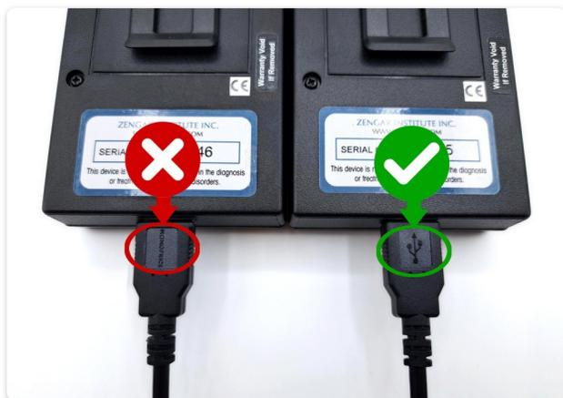
4. Insérez le câble USB dans le port USB du système.
