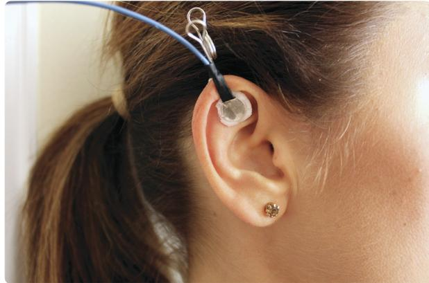
**7.** Appliquez la pâte de la même manière sur le clip noir du capteur et appuyez doucement sur le lobe de l'oreille. Inutile de retirer les boucles d'oreilles ; assurez-vous simplement que la pâte ne les touche pas. Vous pouvez ajuster la position du clip pour les contourner.
